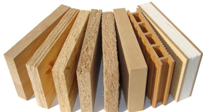
Obrázok 1 Materiály na báze dreva (zlava škárovka, preglejka, doska z orientovaných plochých triesok tzv. OSB doska, drevotriesková doska, izolačná vláknitá doska, MDF doska so strednou hustotou, drevoplastová doska tzv. WPC, sendvičový panel)
