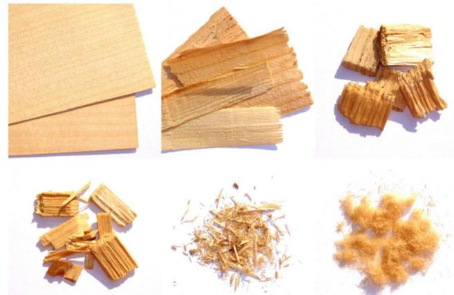
Obrázok 2 Drevné elementy používané pre výrobu materiálov na báze dreva (zlava zhora: dyhy, veľké ploché triesky pre výrobu OSB, biela (papierenská) štiepka, štiepka pre výrobu triesok a vlákien, triesky, vlákna)
