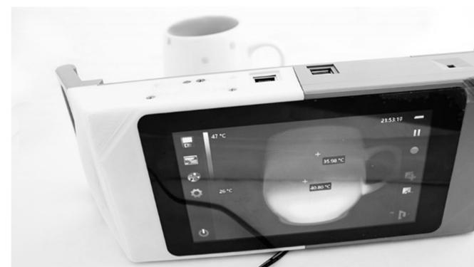
Obr. 1 Prototyp termokamery s testovanou verzí uživatelského rozhraní
