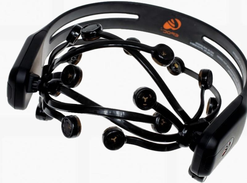
Súčasťou snímača mozgových vĺn EPOC okrem samotného hardvéru je softvérové vývojové prostredie SDK, ktoré umožňuje spracovanie a tým aj ďalšie využívanie nasnímaných surových EEG dát. Po preskúmaní potrebných podkladov sme navrhli úpravu štandardnej aplikácie pre možnosti jej využitia telesne znevýhodnenými ľuďmi. Takáto aplikácia je výsledkom tejto práce.
