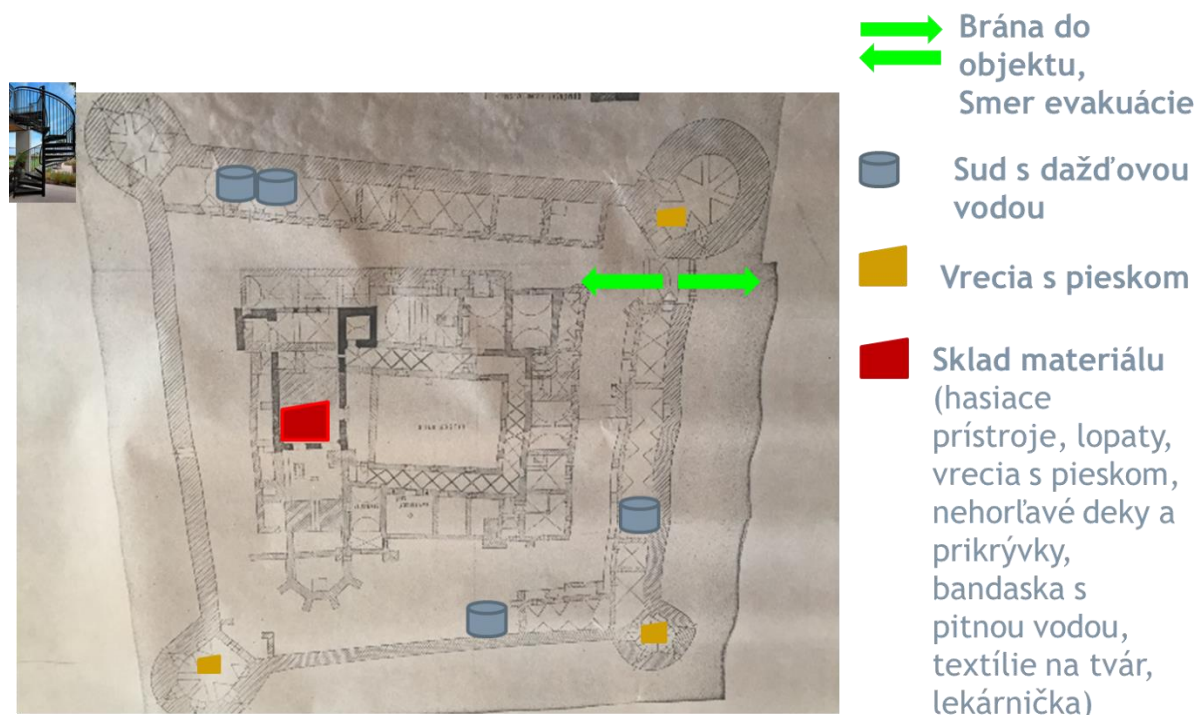
Obr 3 Prezentácia základných opatrení na vybavenie pre požiarnu bezpečnosť hradu Bzovík na pôdoryse hradu.
