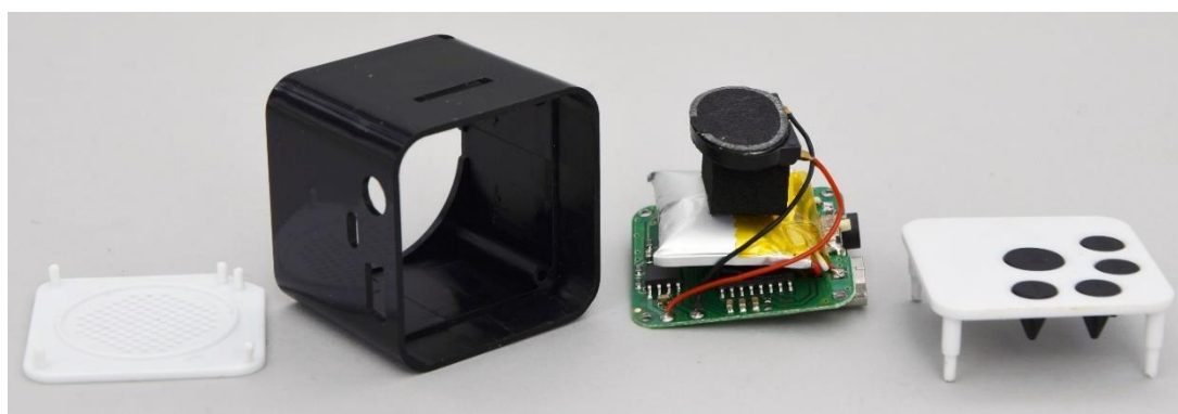
Obr. 2: Zľava doprava: predná mriežka MP3 prehrávača, hlavné puzdro, plošný spoj s elektronickými komponentmi, Li-Po akumulátorom a malým reproduktorom podloženým pružnou penovou hmotou a zadná strana prehrávača s tlačidlami
